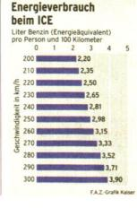
Bei 320 Kilometer pro Stunde Spitzengeschwindigkeit benötigt ein ICE fast doppelt so viel Energie wie bei 200 Kilometer pro Stunde.
