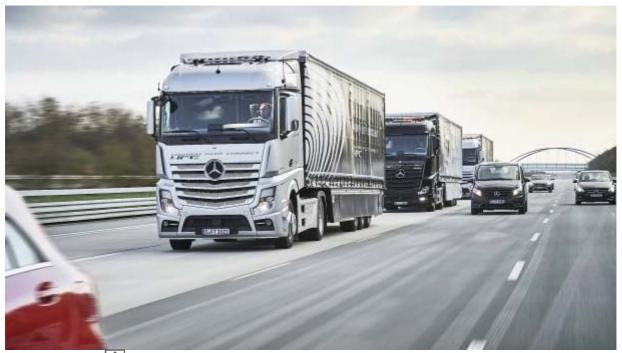
© Daimler AG Laster mit Autopilot: Ein Mercedes-LKW mit dem Highway Pilot Connect-System
